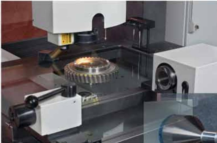
Der optional erhältliche Prüfspindelbock mit Gegenhalter, als voll integrierte stufenlose CNC-Achse mit Standard- oder kundenspezifischen Schnittstellen, bietet ein breites Spektrum an Messmöglichkeiten.
